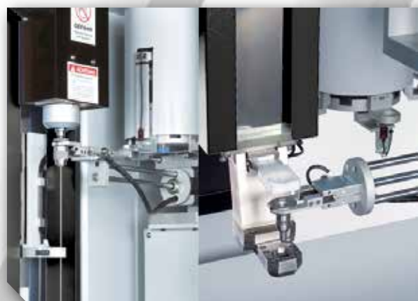
Genomföring och CNC-elektroväxlare ATC (li.), CNC-styrningsväxlare AGC (re.)
