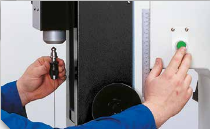
Tillv. utrustning man. maskiner: Pneum. snabbväxlingsystem för elektroder
